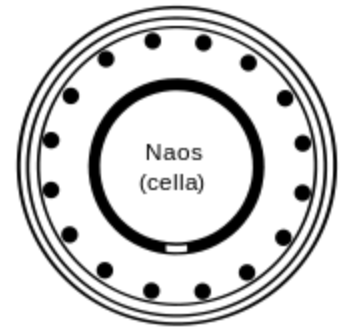
TOLO. Circular, con columnas alrededor
